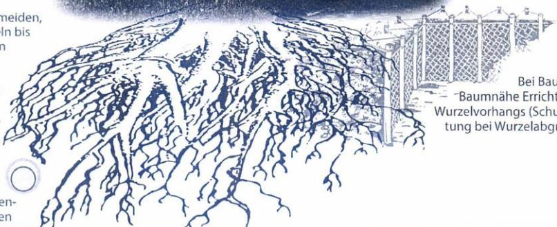
Bei Baugruben in Baumnähe Errichtung eines Wurzelvorhangs (Schutzvorrichtung bei Wurzelabgrabungen)
