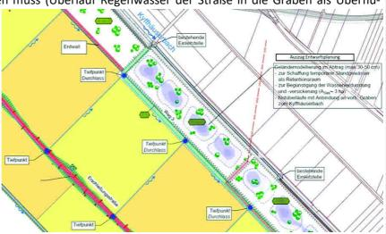
wurde unter Berücksichtigung der Kapazität des Kyffhäuserbachs ermittelt und entspricht damit dem derzeitigen Zustand. Das Niederschlagswasser kann über die vorhandenen Gräben in die Vorflut gelangen bzw. sich flächig im Bereich der Maßnahmen A<sub>CEF</sub>1 und A<sub>CEF</sub>2 verteilen (Retention/ Versickerung). Hierfür werden weiteräumige, flache Geländesenken mit einer Tiefe von max. 0,60 m (kein Grundwasser-Anschnitt) angelegt.
